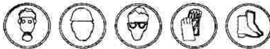
USO OBLIGATORIO DE MASCARAS USO OBLIGATORIO DE GAFAS PROTECCION USO OBLIGATORIO DE GAFAS USO OBLIGATORIO DE GUANTES USO OBLIGATORIO DE BOTAS DE CHUZO
