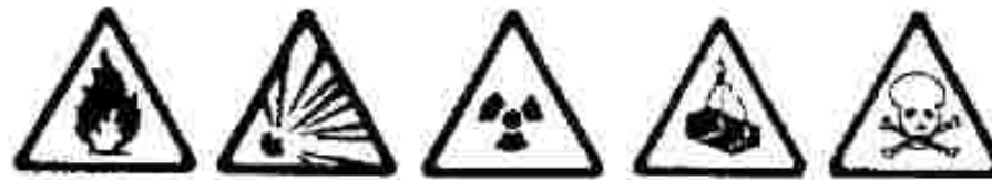
RIESGO DE INCENDIO MATERIAL COMBUSTIBLE RIESGO DE EXPLOSION MATERIAL EXPLOSIVO RIESGO DE RAYOS RIESGO DE CARGAS SUSPENDIDAS RIESGO DE INTOXICACION
