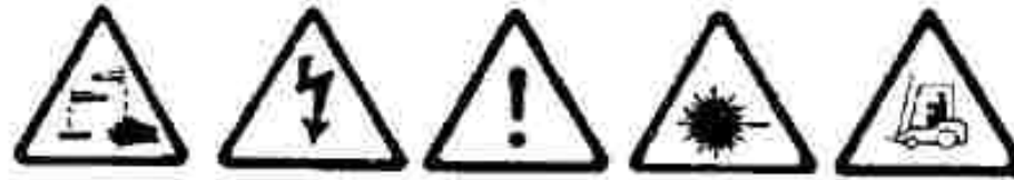
RIESGO DE CORROSION RIESGO ELECTRICOS RIESGO GENERALIZADO RIESGO DE IRRITACION CARGAS MOVILES MANUTENCION
