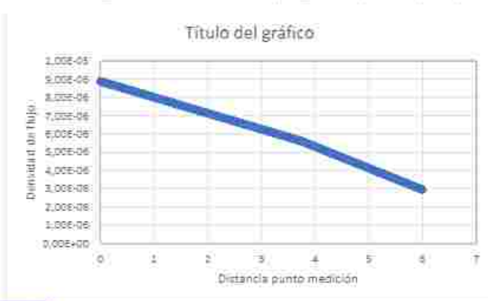
Fig. 2 Variación de la densidad de flujo entre la fuente de campo y el punto de medición
