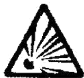
RIESGO DE EXPLOSION MATERIAL EXPLOSIVO
