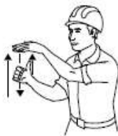
4 LEVANTAR EL AGUILÓN O PLUMA LENTAMENTE
