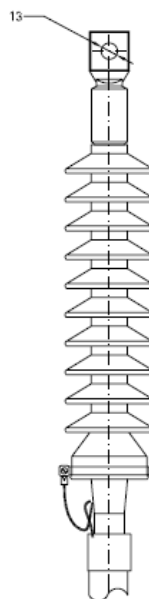
Figura 12. Terminales de exterior.
