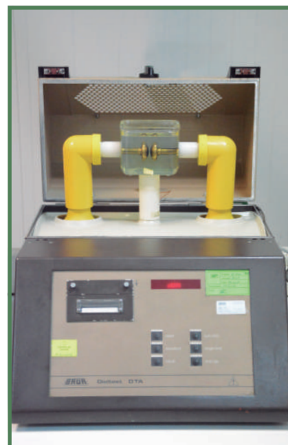
Análisis para la determinación rigidez dieléctrica líquido dieléctrico
