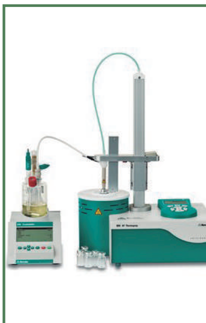
Análisis para la determinación humedad líquido dieléctrico
