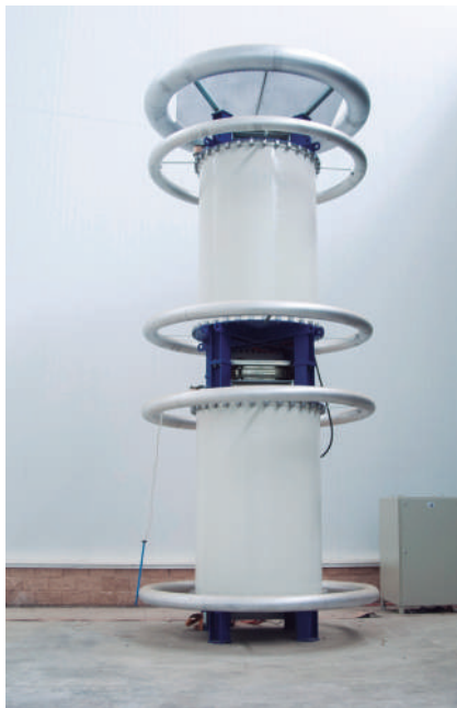
Sistema de tensión aplicada
