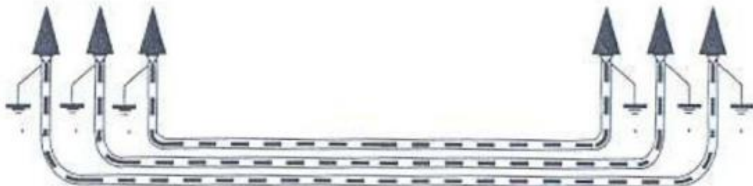
Figura 7: Puesta a tierra de cubiertas metálicas.
