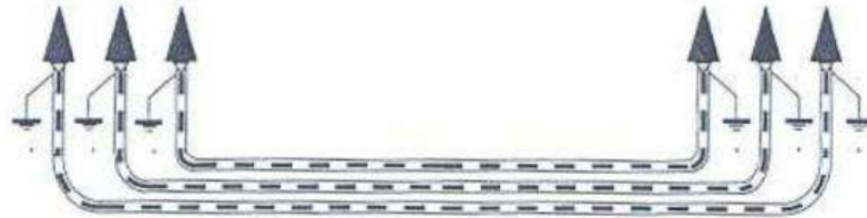
Ilustración 25. Puesta a tierra cubiertas metálicas
