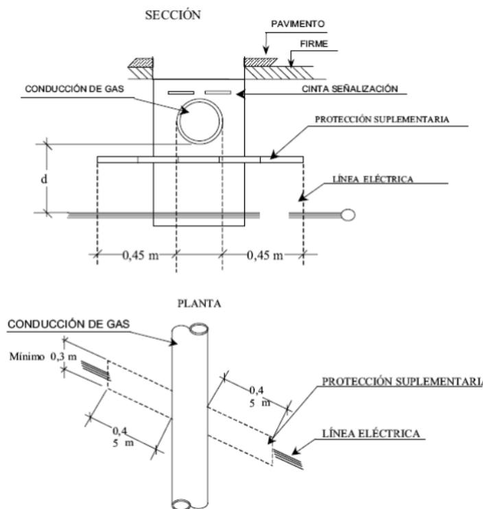
**Figura 26: Detalles de cruzamiento y conducciones (ITC-LAT 06).**
