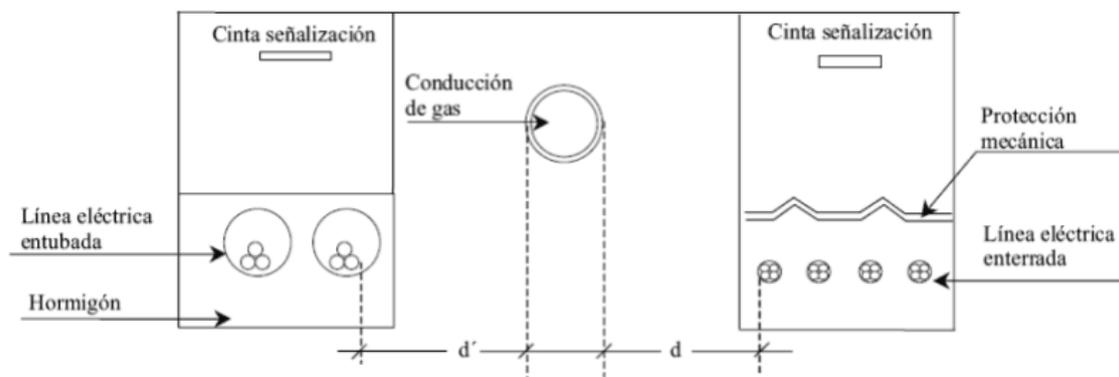
**Figura 28: Detalles de paralelismo y conducciones (ITC-LAT 06).**
