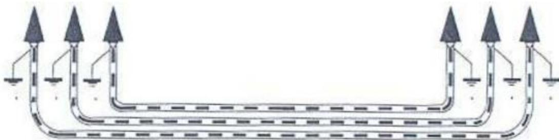
*Figura 24: Puesta a tierra de cubiertas metálicas.*
