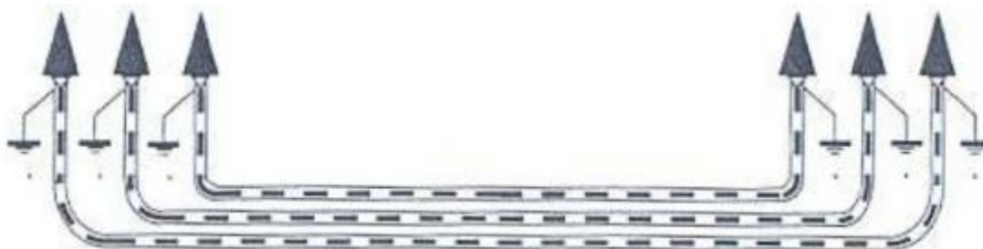
Figura 24: Puesta a tierra de cubiertas metálicas.
